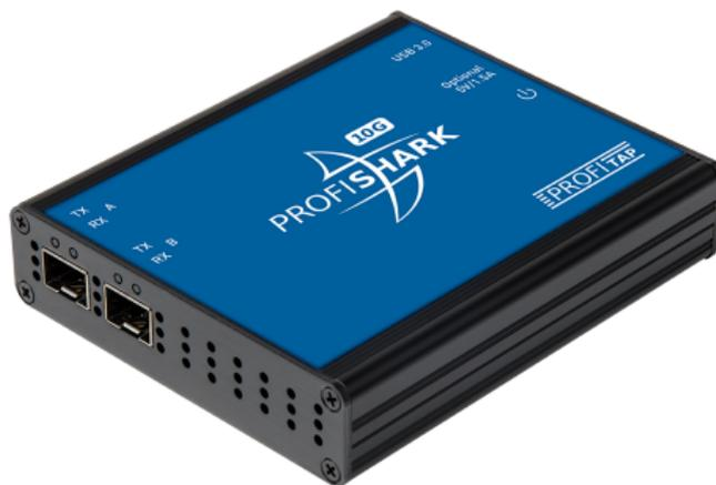
La communication réseau obéit à un protocole défini dans les normes IEEE (Institute of Electrical and Electronics Engineers). Il est donc possible de comprendre les informations qui transitent sur un câble réseau en s'interconnectant sur le câblage.
